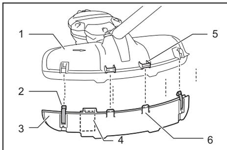
► 1. Protector 2. Clip 3. Protector extension 4. Cutter 5. Slot 6. Tab
