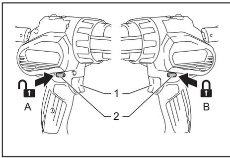
► 1. Switch trigger 2. Trigger-lock button
